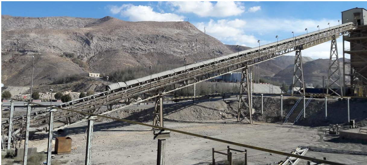
شکل شماره ۱۲: ادامه نوار شماره ۴۰ از سنگ شکن به سمت مخازن هشت گانه
