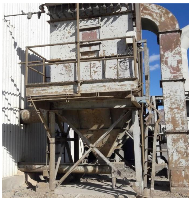
شکل شماره ۹: سیستم غبار گیر و اسکرو زیر آن
