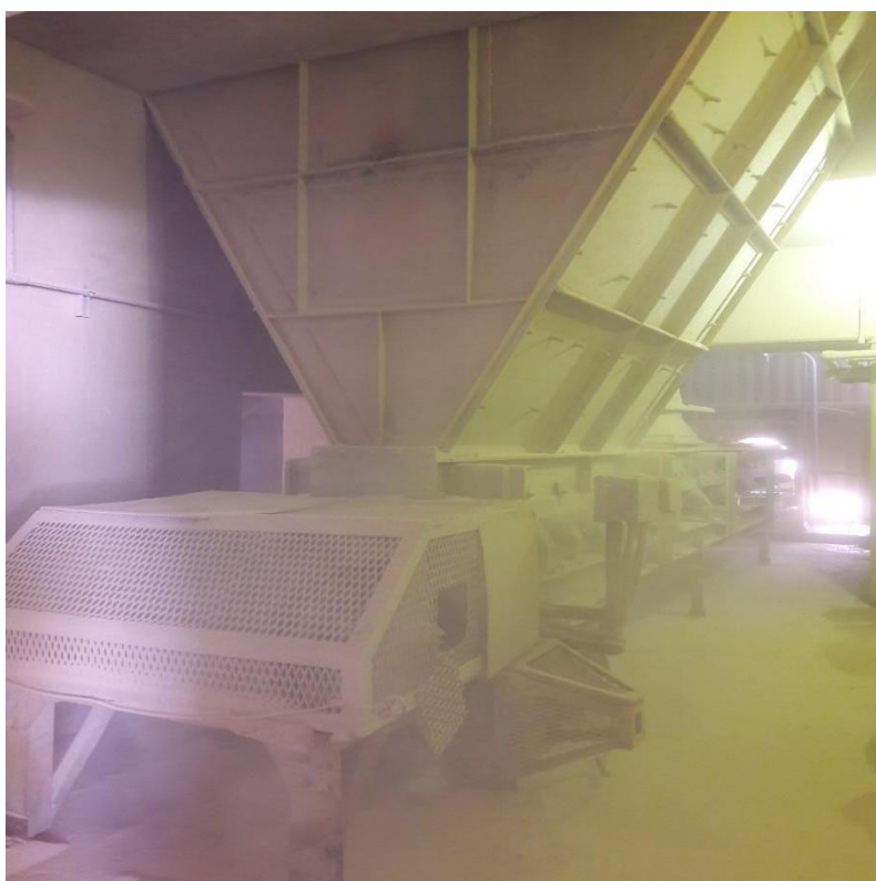
شکل شماره ۲۶: نرمة آهک و سیلیس از نوار ۴۳ بر روی نوار ۴۲ ریخته می‌شود.
