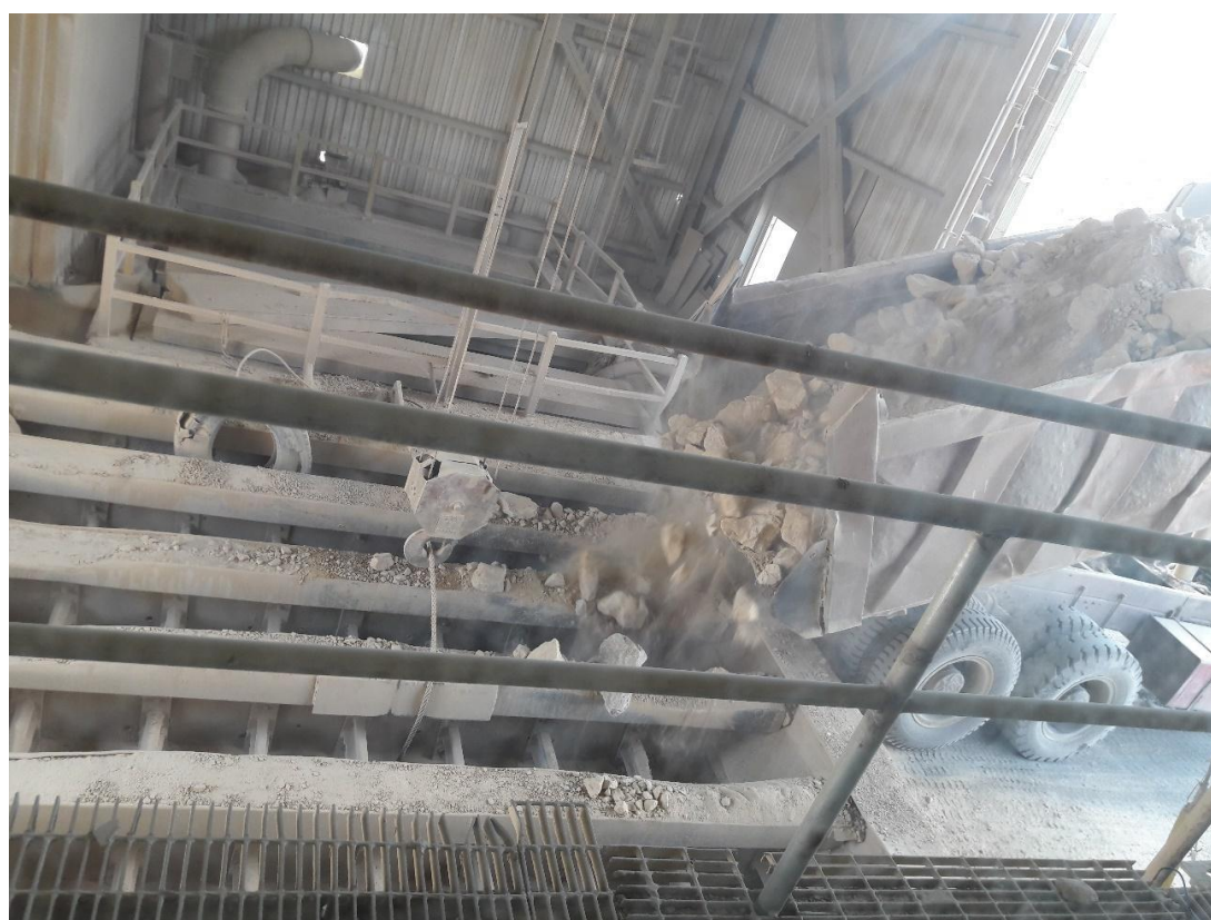
شکل ۴: کامیون در حال خالی کردن سنگ آهک مخلوط بر روی گریزلی
