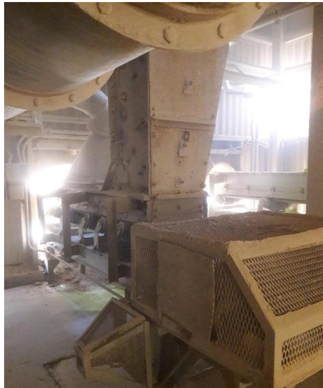
شکل شماره ۳۰: سنگ سیلیس درشت از نوار ۴۳ بر روی نوار ۴۴ می ریزد
