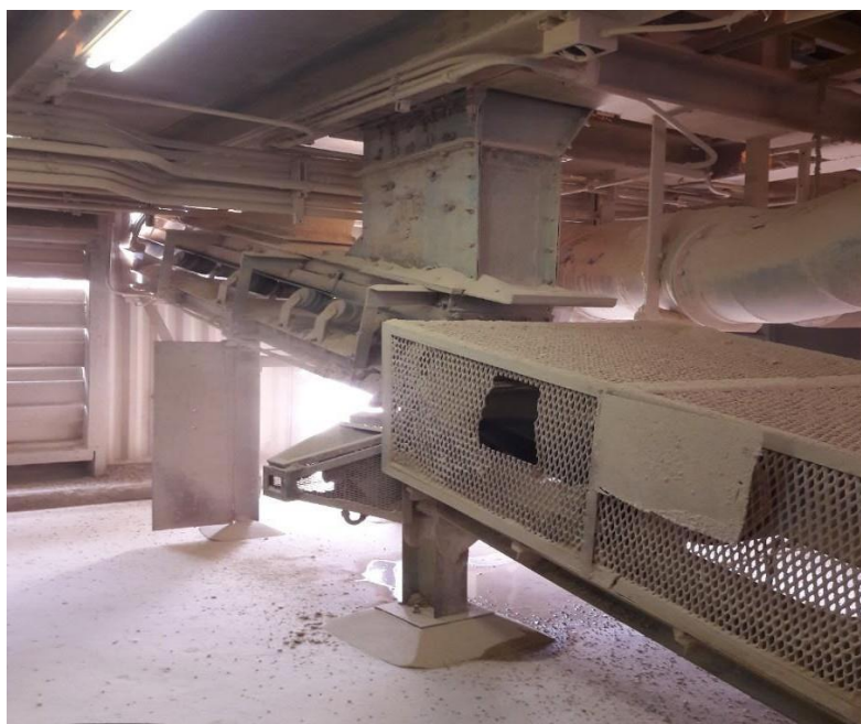
شکل شماره ۲۷: سنگ‌های خرد شده آهک از نوار ۴۳ بر روی نوار ۴۵ می‌ریزد
