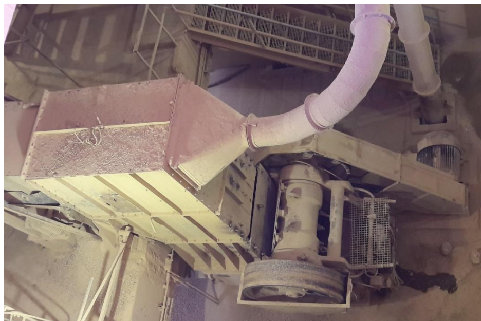
شکل شماره ۸: غبار حاصله به سیستم غبار گیر هدایت می‌شود
