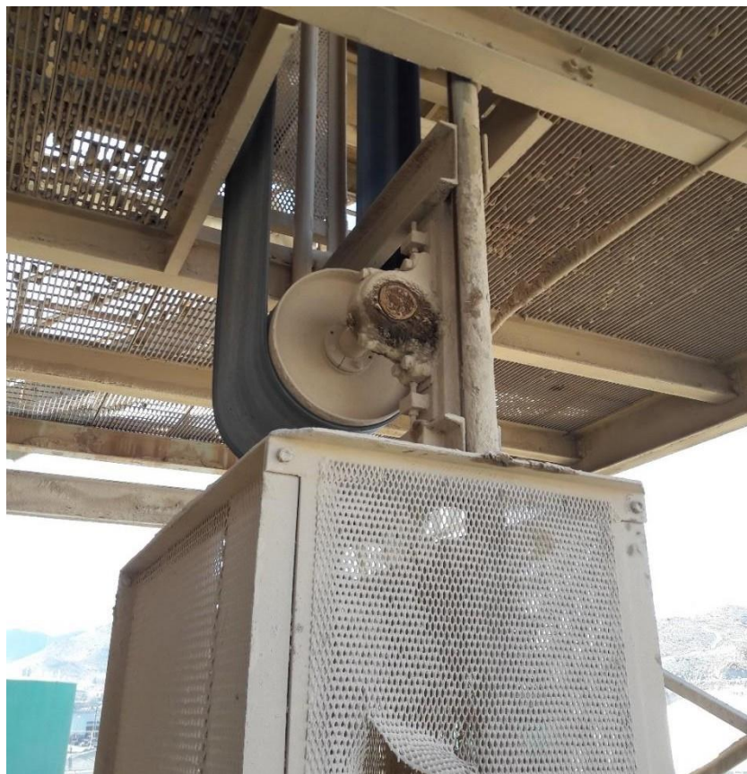
شکل شماره ۱۶: تنظیم نوار با حرکت تریپر
